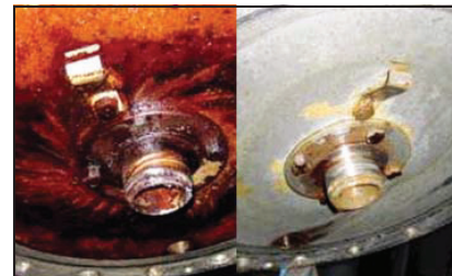
Capacul recipientului este contaminat curățare
